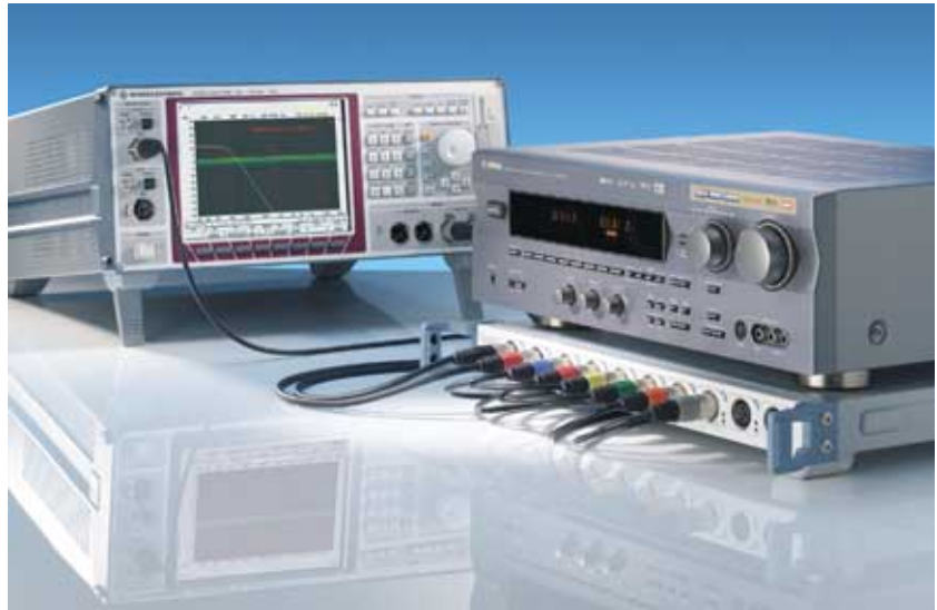
Mehrkanal-Messungen an einem Audio-/Video-Receiver
